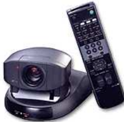
Abbildung 1.9: Die verwendete Tracking-Farbkamera Sony EVI-D31 . Viele Kameraparameter lassen sich mit einer Infrarot Fernbedienung als auch über die serielle Schnittstelle eines Computers einstellen.
