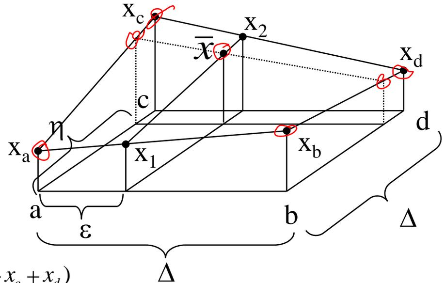
Man erhält das gleiche Ergebnis, wenn man  $x_b$  gegen  $x_c$  sowie  $\varepsilon$  gegen  $\eta$  vertauscht, d.h. man könnte auch zuerst bzgl.  $(x_a, x_c, \eta)$  und  $(x_b, x_d, \eta)$  interpolieren und dann linear über das Ergebnis davon mit  $\varepsilon$ .
