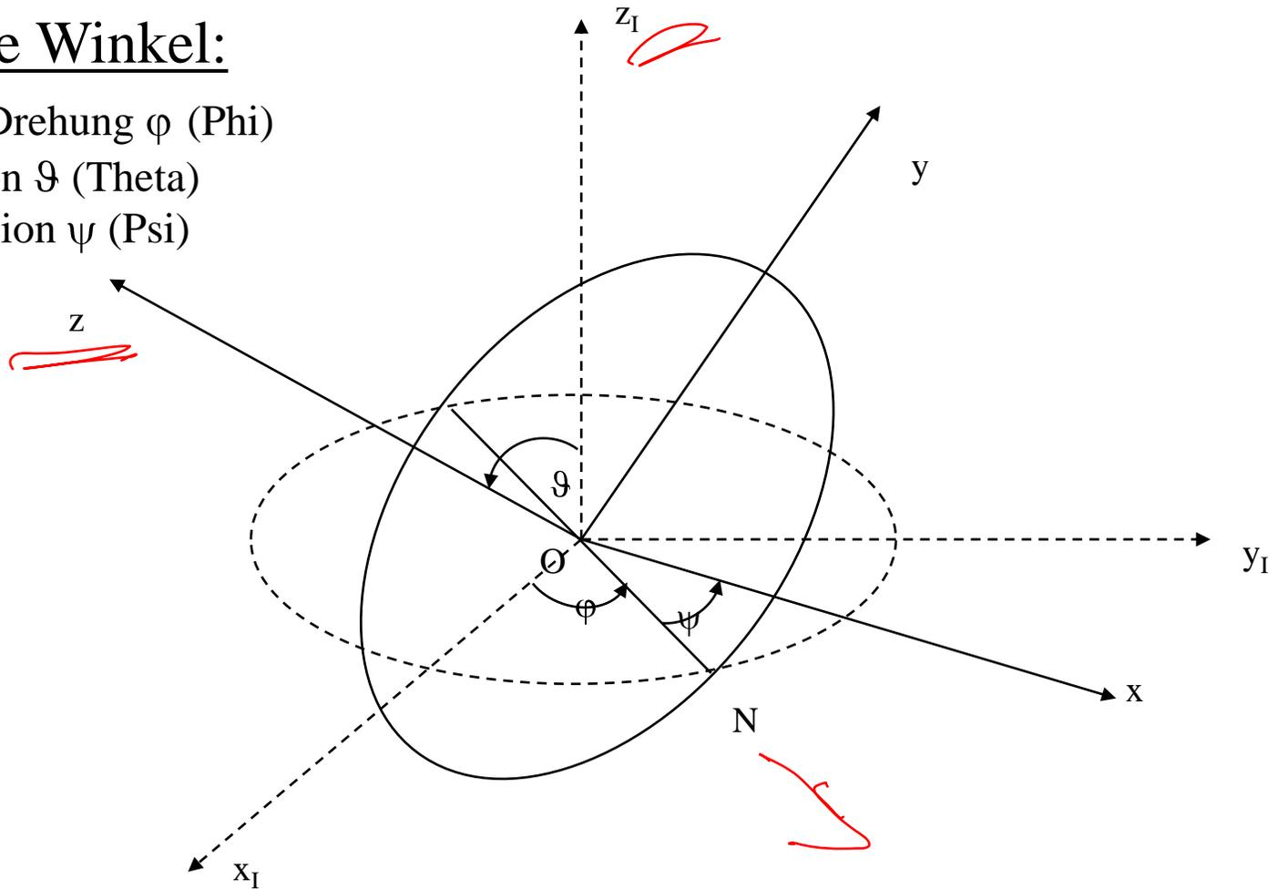
Der Übergang vom Inertialsystem auf das körperfeste System wird mit den drei folgenden Drehungen realisiert:
