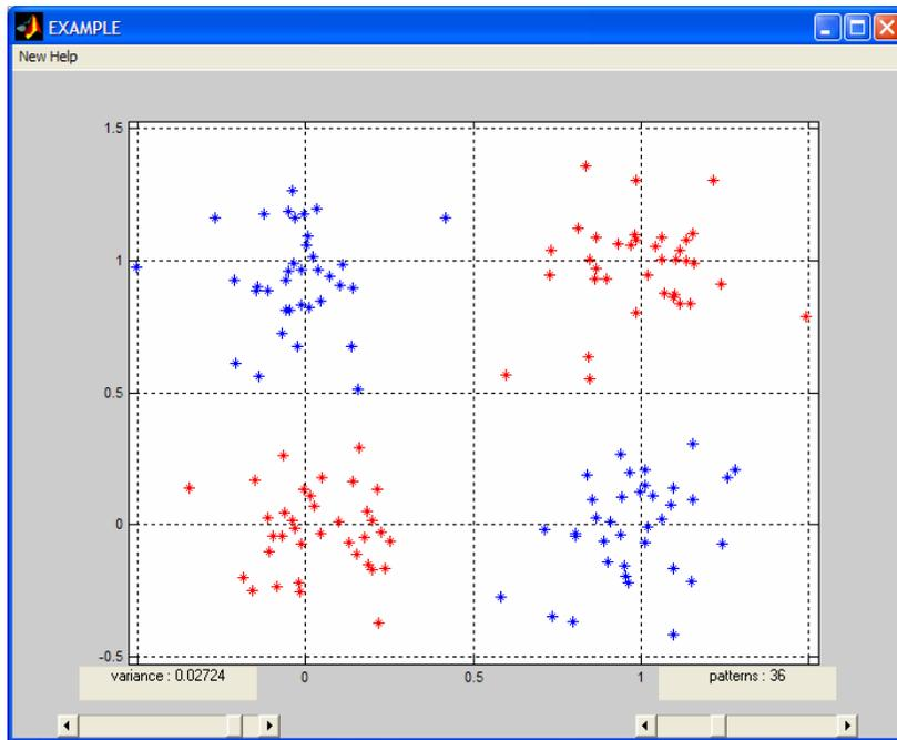
XOR mit hohem Rauschanteil um zweite Lösung zu provozieren! Mit zwei Geraden schafft man keine fehlerfreie Konstellation. Der Gradient kann trotzdem verschwinden bei einem von Null verschiedenen Fehlermass, d.h. man ist in einem Nebenmaximum. Erst die richtige Lösung führt auf einen Fehler Null.
