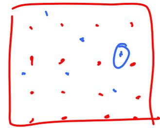
Bei der Rotation und bei der Translation um Bruchteile des Abtastintervalls ist eine Interpolation der Grauwerte von Bildern erforderlich (nichtgitterkonforme Abbildungen). Dies lässt sich am einfachsten durch a) die Nächste-Nachbar-Regel realisieren:
