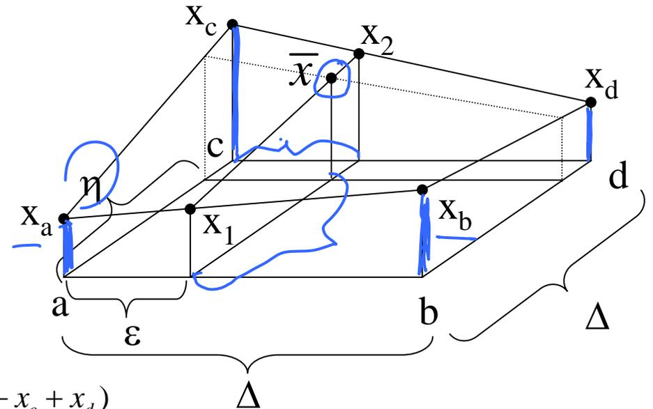
Man erhält das gleiche Ergebnis, wenn man  $x_a$  gegen  $x_c$  sowie  $\varepsilon$  gegen  $\eta$  vertauscht, d.h. man könnte auch zuerst bzgl.  $(x_a, x_c, \eta)$  und  $(x_b, x_d, \eta)$  interpolieren und dann linear über das Ergebnis davon.
