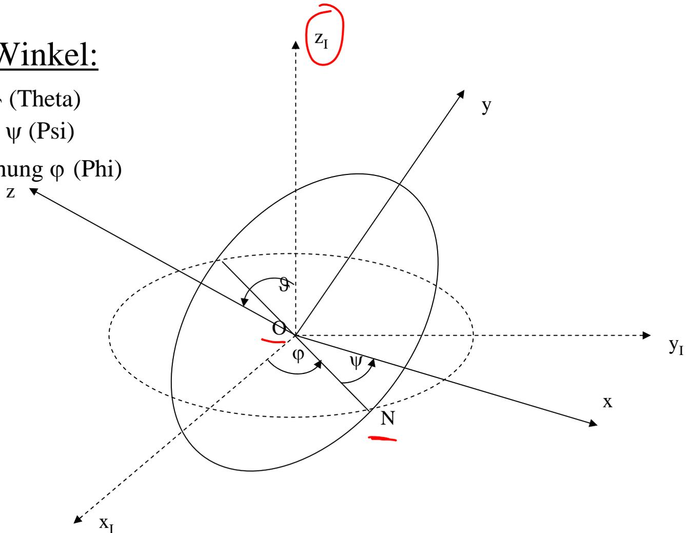
Der Übergang vom Inertialsystem auf das körperfeste System wird mit den drei folgenden Drehungen realisiert:
