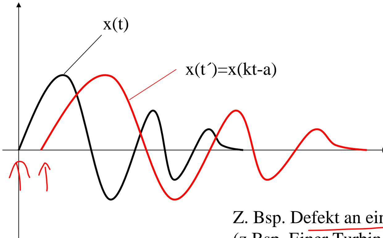
Z. Bsp. Defekt an einem rotierenden Teil (z.Bsp. Einer Turbinenschaufel) bei unterschiedlicher Drehzahl (oder sogar zeitvarianter Drehzahl) (siehe unten).
