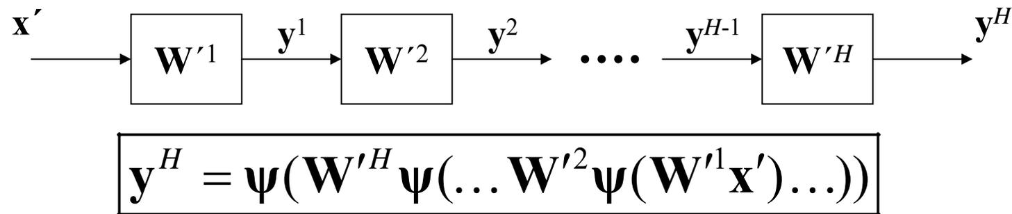
Das Lernen basiert auf der Anpassung der Gewichtsmatrizen, mit dem Ziel der Minimierung eines Fehlerquadrat-Kriteriums zwischen dem Sollwert  $\mathbf{y}$  und der Approximation  $\hat{\mathbf{y}}$  durch das Netz (überwachtes Lernen). Der Erwartungswert ist zu bilden über das zur Verfügung stehende Trainings-Ensemble von  $\{\hat{\mathbf{y}}_j, \mathbf{x}_j\}$ :
