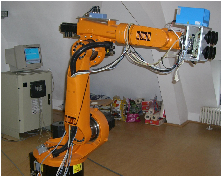
Abbildung 2.2: Aufbau der Scanaparatur mit Kuka Industrieroboter und SICK Laserscanner LMS 400-00
