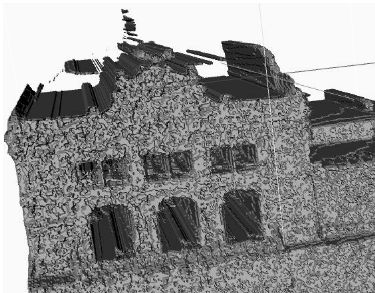
Abbildung 2.7: Tiefenbild eines Modellhauses mit schwarzem Dach, welches nur teilweise erkannt wurde.
