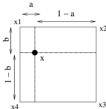
Der Grauwert  $x$  lässt sich mit Hilfe von bilinearer Interpolation so berechnen:
